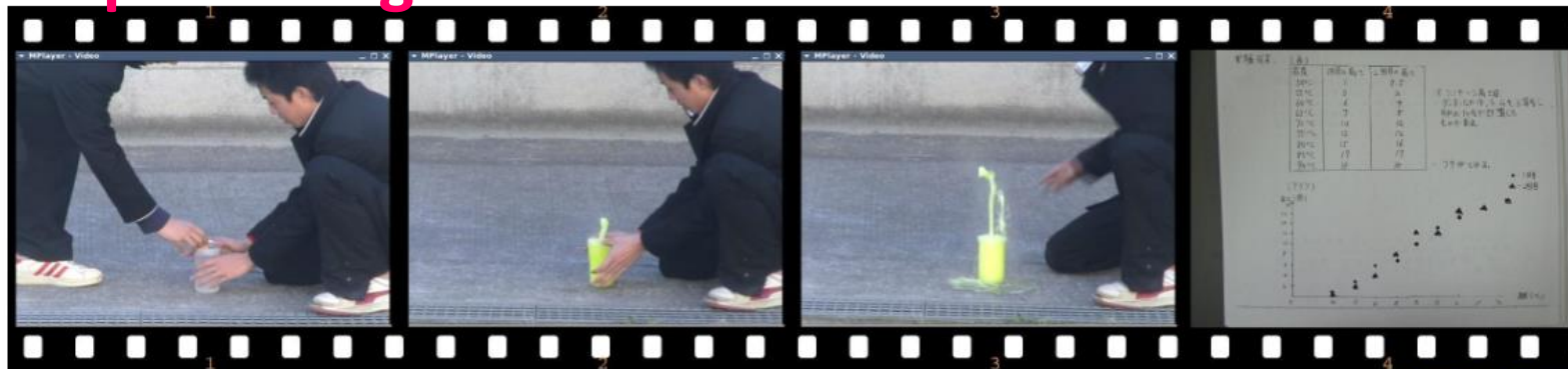
図10. バブとお湯による噴火実験. 噴水の高さが温度に比例.
