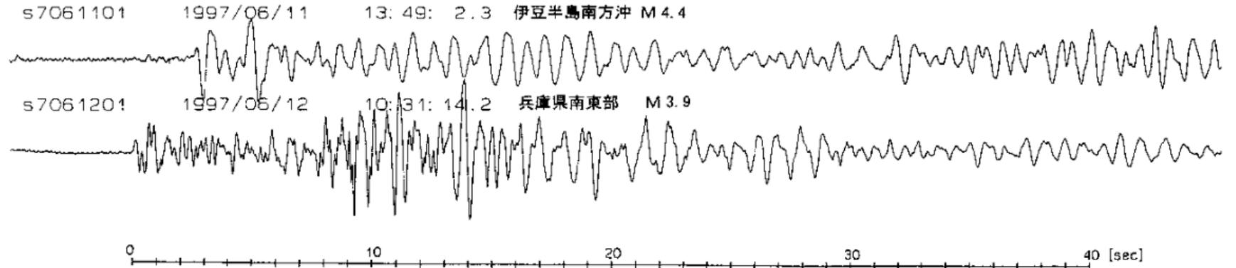
図3 図2の改良センサーによる記録波形 (震源は気象庁速報値による。図はいずれも文献より引用)
