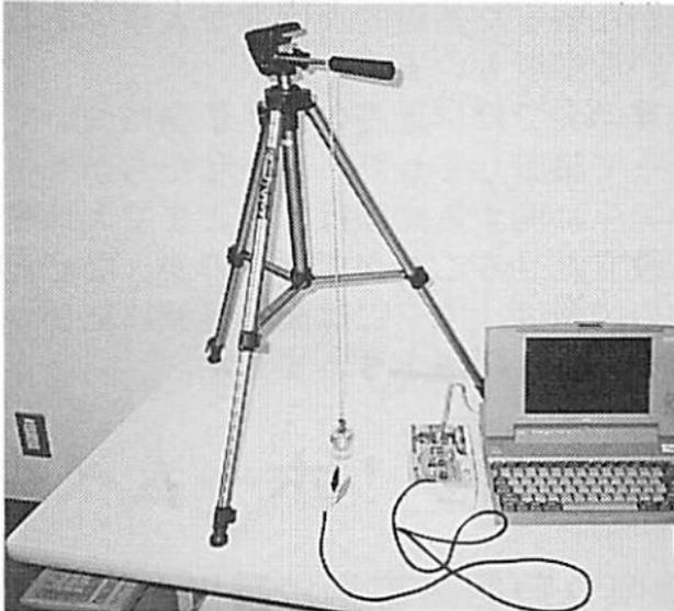
図1 フィルムケース地震計全景
